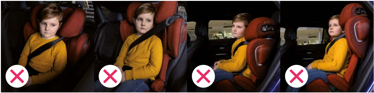
Bezpečnostní pás překroucen v místě klíční kosti. Špatné vedení bezpečnostního pásu, není dle instrukcí výrobce. Hlavová opěrka příliš nízko, trup se nevejde do zadové opěrky. Hlavová opěrka je příliš vysoko, pás vede v těsné blízkosti krku.
