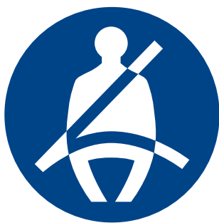
Obrázek č. 1: Piktogram upozorňující na povinnost používat zádržný bezpečnostní systém stanovený pro vozidla kategorií M2 a M3
